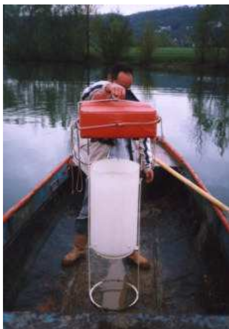
Figure 27 : Mise en place au milieu de l'étang du piège à MES le 29/09/2000 à partir d'un bachot.
