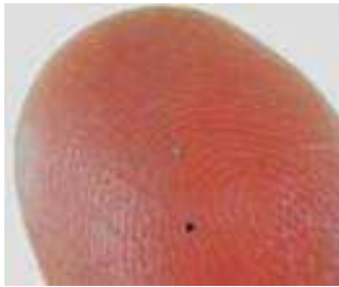
FIGURE 1.11 – Puce RFID de marque Hitachi mesurant 0,4 \times 0,4 mm
