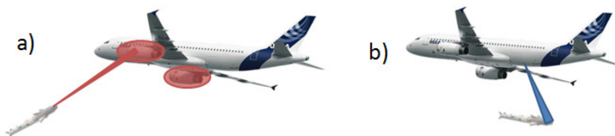
Figure 1-5: schéma du principe de la contre-mesure optique. a) Le missile est guidé par un point chaud de l'avion b) Le missile est dévié de sa trajectoire grâce au laser en émettant un rayonnement équivalent à celui détecté par le missile.
