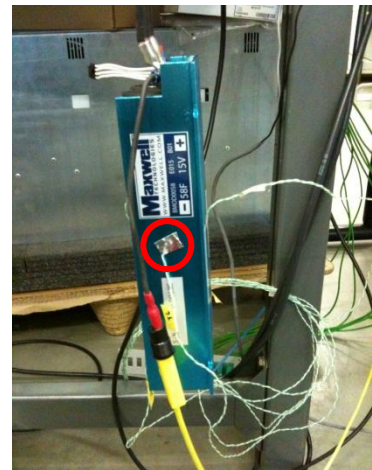
Figure 2.17 : Photographie des équipements de mesure complémentaires.
