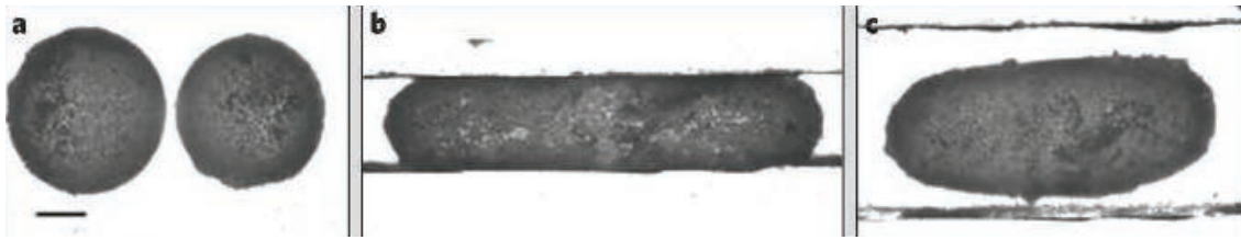
Figure II-9 : a) Deux bulles de gaz stabilisées par une couche dense de particules de polystyrène b) Compression des bulles de gaz entre deux lames de verres et coalescence c) Morphologie ellipsoïdale maintenue stable même après avoir retiré les lames de verre [59] .
