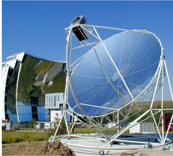
FIGURE 1.15 – Moteur Stirling solaire étudié par le CNRS dans le cadre du programme "EuroDish" à Odeillo
