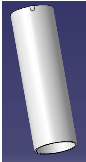
FIGURE 3.11 – Remplacement du cylindre isolant par un tube en inox
