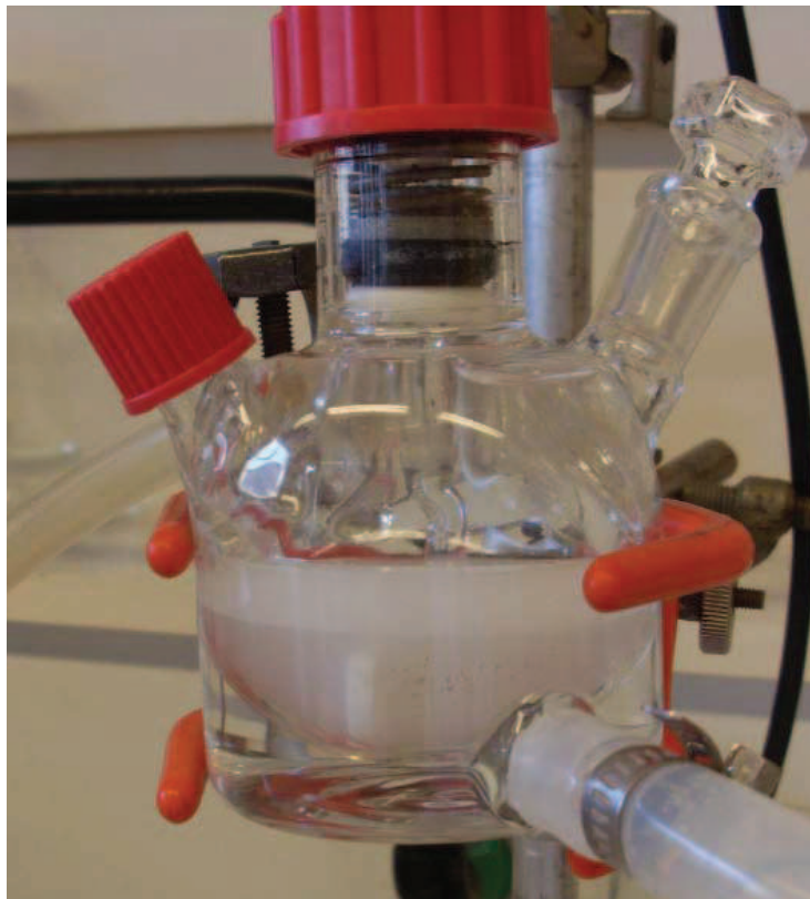
Figure B.3- Déphasage de l'émulsion après arrêt de l'agitation
