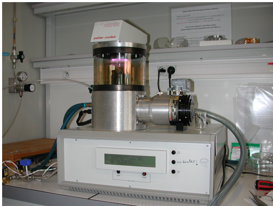
FIGURE 3.1 – Photo du pulvérisateur (Emitech K575X ) utilisé pour déposer les films métalliques.
