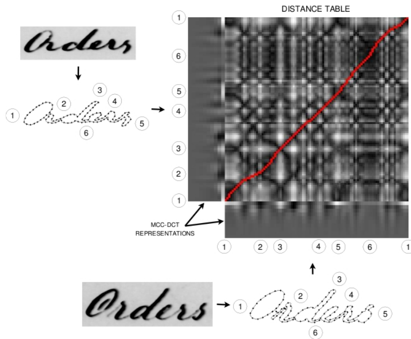
FIG. 2.21: Distance mesurée par DTW entre deux images caractérisées par le vecteur MCC-DCT . Illustration extraite de [Adamek 2007].
