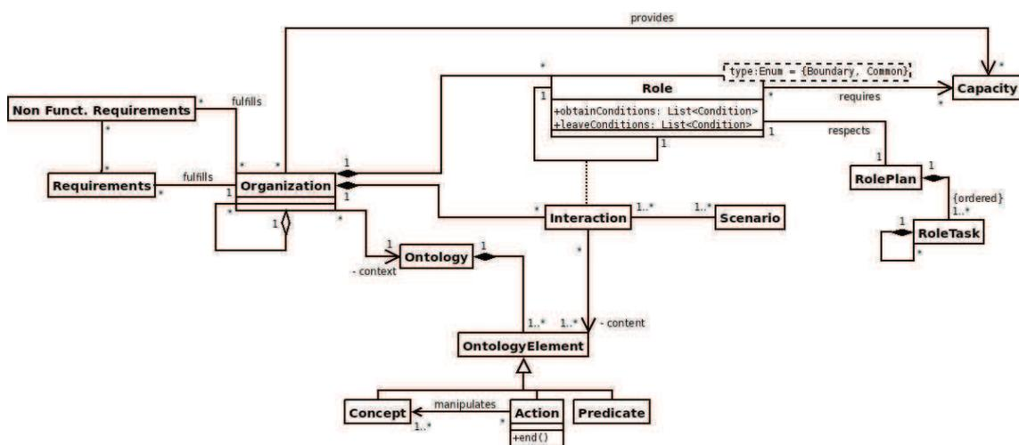
FIGURE 2.1 – Diagramme UML du domaine du problème du métamodèle CRIO
