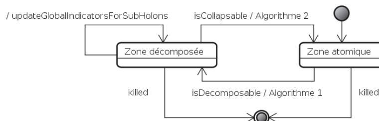
FIGURE 5.5 – Machine à état d'un holon de l'environnement
