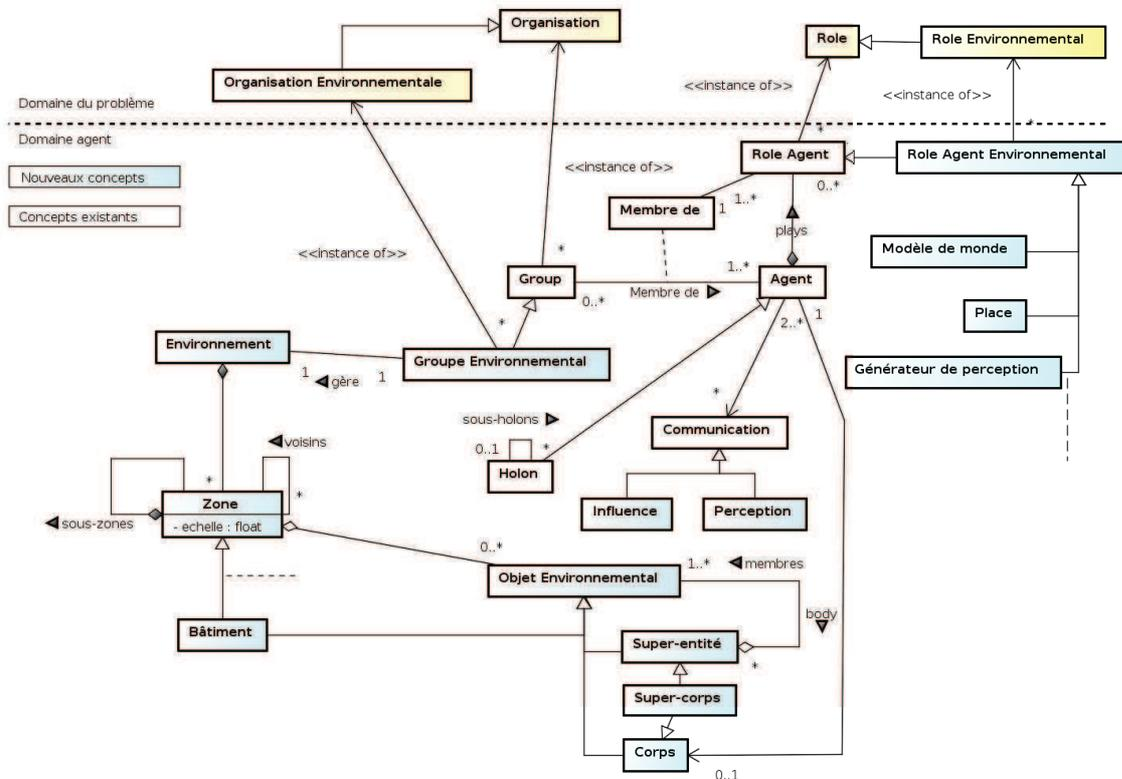
FIGURE 5.1 – Diagramme UML de l'extension du domaine "agent" du métamodèle CRIO pour la modélisation du SMA de l'environnement intérieur
