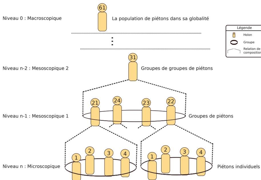
FIGURE 4.2 – Exemple d'une holarchie d'une simulation de piétons
