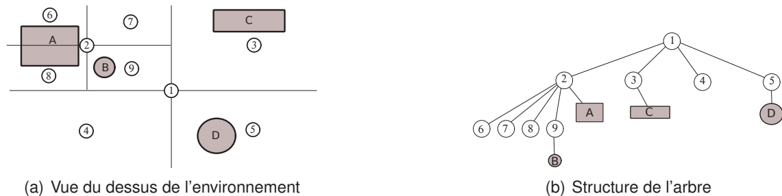
FIGURE 4.8 – Exemple de décomposition dynamique d'une zone par un arbre kD -tree, avec k = 4
