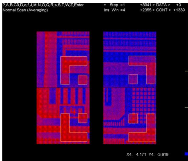
Figure 3-37 Image prise lors de la procédure d'alignement d'une étape d'électrolithographie réalisée à l'UdeS.
