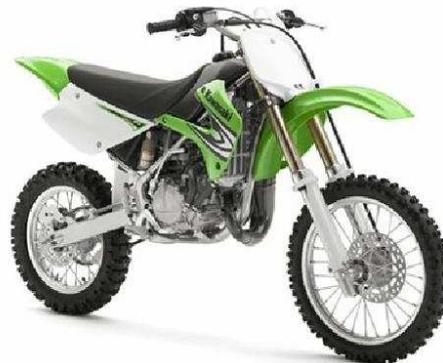
**Moto cross**, non homologuée, maniable, puissante, avec des pneus à tétines favorisant une bonne accroche, ces motos sont utilisées sur circuits cross avec pour objectif de parcourir les boucles le plus vite possible
