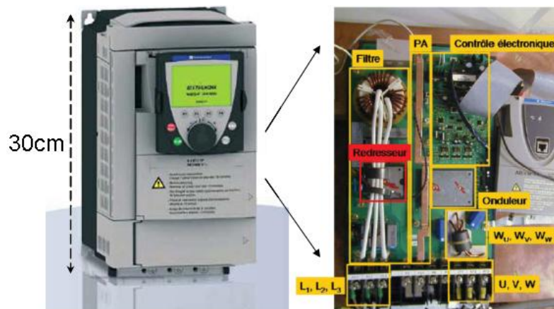
Figure 2 : Variateur de vitesse ATV71.
