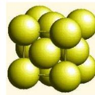
Figure III.52 : Arrangement CFC
