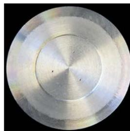
Figure II.5 : Exemple d'un élément de mélange :  $n = 3$ ,  $d_{\text{trou}} = 0,5 \text{ mm}$  et  $L_{\text{trou}} = 2 \text{ mm}$
