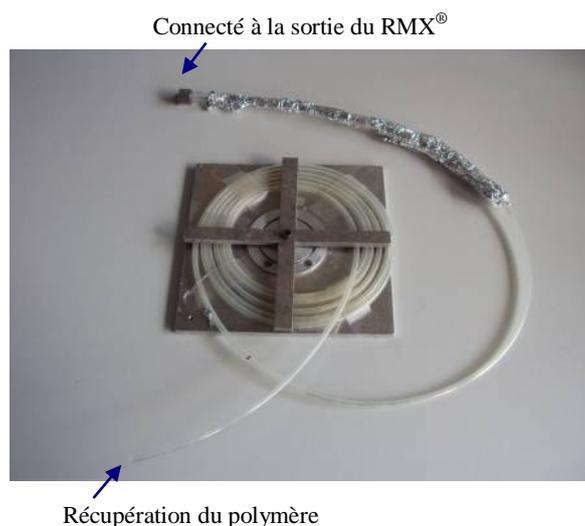
**Figure V.9 : Montage de photopolymérisation**
