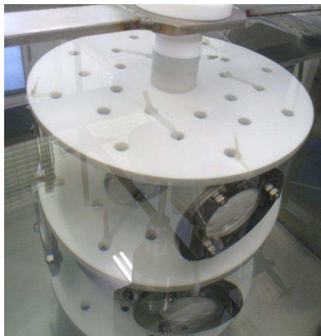
Figure 28 : Pilote en flux continu pour la calibration des POCIS et montage sur carousel.
