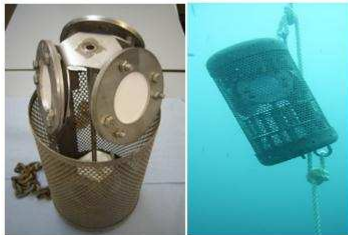
Figure 19 : Cage de déploiement conçue pour l'exposition des POCIS (Cefas).
