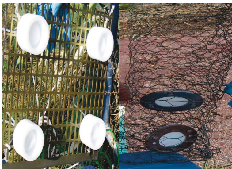
Figure 48 : Chemcatcher (à gauche) et POCIS (à droite) en cours de montage dans les cages de déploiement.
