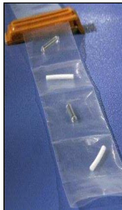
Figure 17 : Échantillonneur MESCO formé d'une membrane en LDPE, séparée par soudure en 4 segments distincts, contenant des tubes en silicone et des barreaux imprégnés d'une couche de PDMS (barreau Twister™) (Nyoni, 2010).
