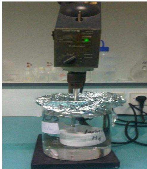
Figure 27 : Montage pour la calibration des Chemcatcher en milieu non renouvelé.
