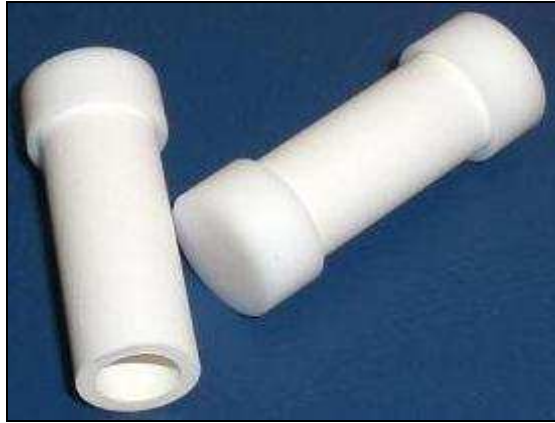
Figure 15 : Dosimètre céramique avec et sans capsule (Nyoni et al, 2010).
