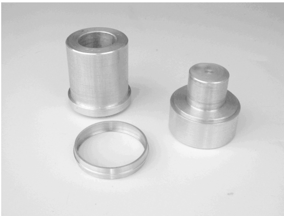
Figure 4.16 - Coque de 44 mm de diamètre et son support d'essai
