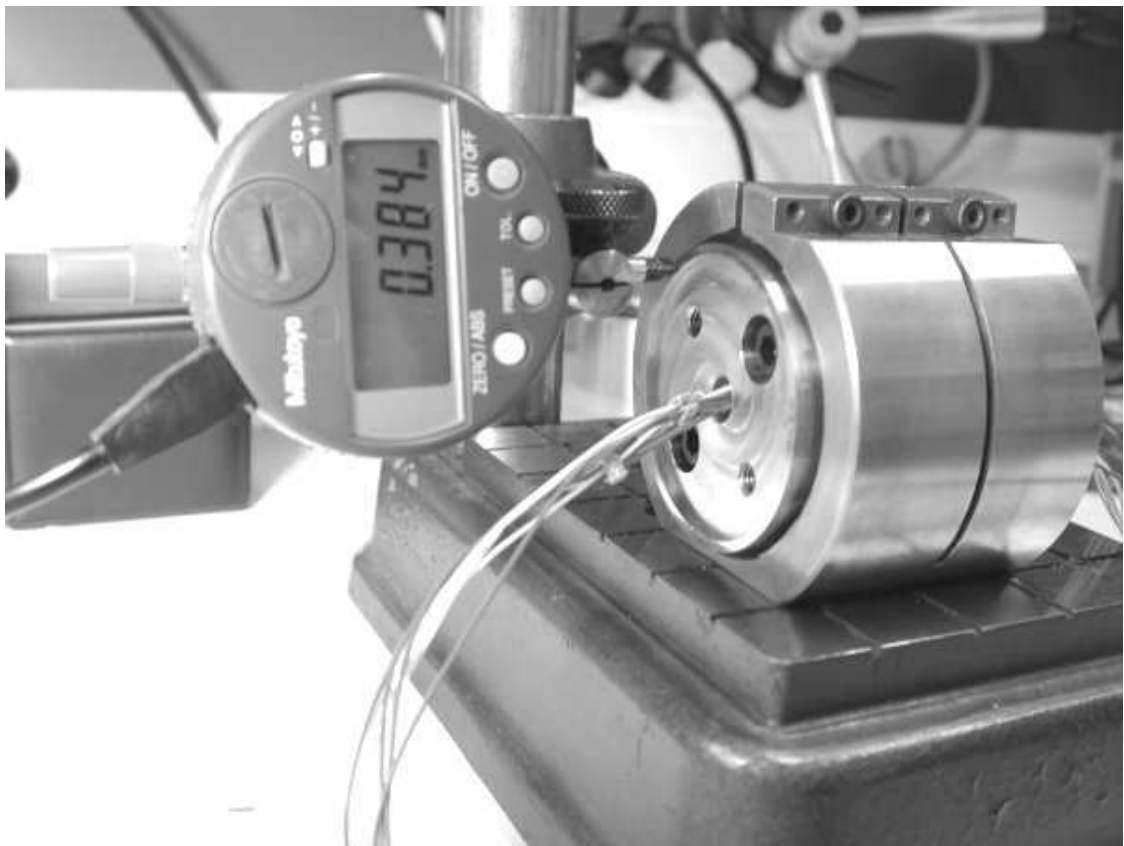
Figure 4.30 - Moteur dans son support lors d'un essai en translation
