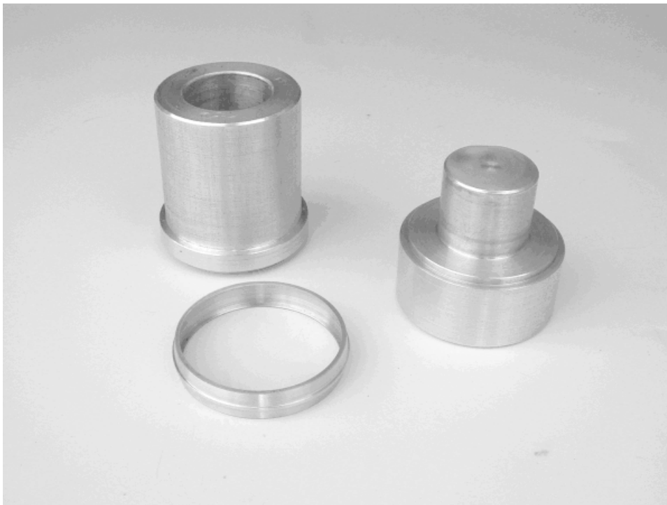
Figure 4.16 - Coque de 44 mm de diamètre et son support d'essai
