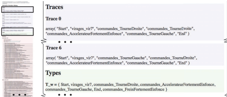
FIGURE 7.5 – Interface d'AUTOMATA : présentation de la liste des séquences (dont les doublons ont été retirés), et de la liste des types d' obsels présents dans ces séquences. À gauche, la vue globale de l'interface montre où se situe cette capture d'écran.
