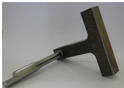
FIGURE D.2 – Éprouvette dans la configuration pour solliciter le premier et / ou le troisième mode propre de la structure. Méplat parallèle au plan de symétrie de la masselotte
