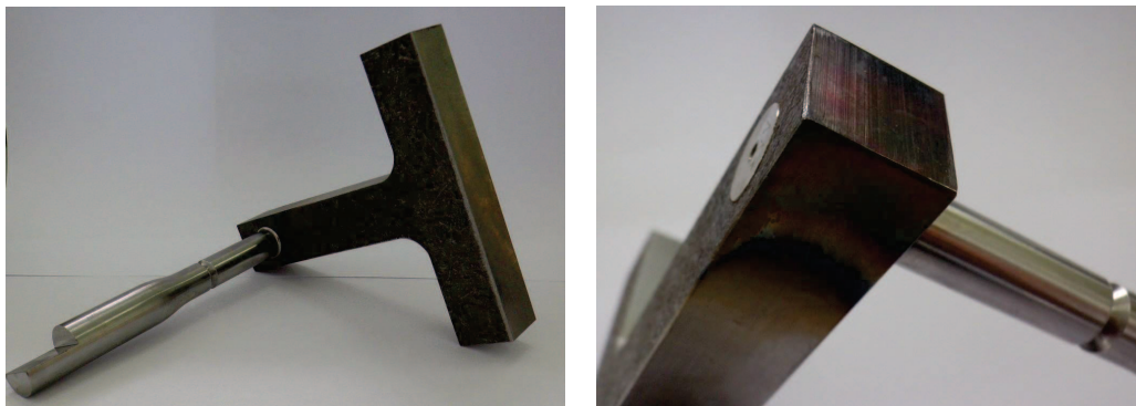
(a) Vue globale de l'éprouvette de fatigue (b) Vue sur la zone de frettage entre la partie cylindrique et la masselotte
