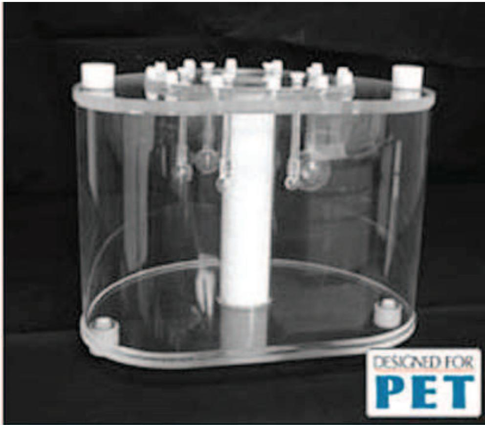
Figure 14: Illustration du « PET Phantom - NEMA IEC/2001 ».
