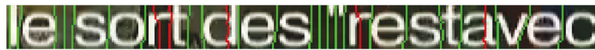
Figure 1: Un exemple de segmentations obtenues : les chemins verts correspondent aux segmentations “fiables” alors que les rouges correspondent aux segmentations “à risque”.
