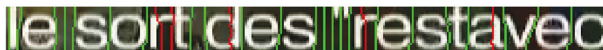
Figure 1: Un exemple de segmentations obtenues : les chemins verts correspondent aux segmentations “fiables” alors que les rouges correspondent aux segmentations “à risque”.
