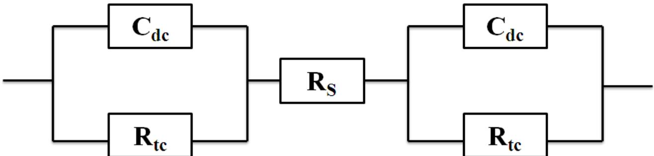
Fig.I.25: Modèle de circuit simplifié équivalent (sans impédance de Warburg) au transducteur conductométrique à deux électrodes interdigitées utilisé dans ce travail
