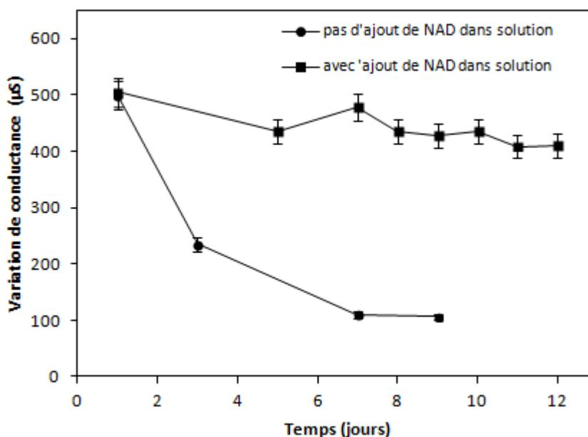
Fig.IV.6 : Effet de l'ajout supplémentaire de 20  $\mu\text{M}$  de  $\text{NAD}^+$  dans la solution de mesure sur la stabilité du signal du biocapteur. 0,045 mg de pFDH et 13  $\mu\text{g}$   $\text{NAD}^+$  co-immobilisés dans la biomembrane [HCHO] = 10 mM dans du tampon phosphate 5 mM, pH 7, T = 23±2°C
