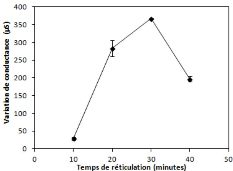
Fig.III.6: Influence du temps de réticulation sur l'intensité du signal du biocapteurs bi-enzymatique LODP/HRP. Mesures effectuées à l'aide d'une solution de 100  $\mu\text{M}$  de L-lactate dans du tampon phosphate 5 mM
