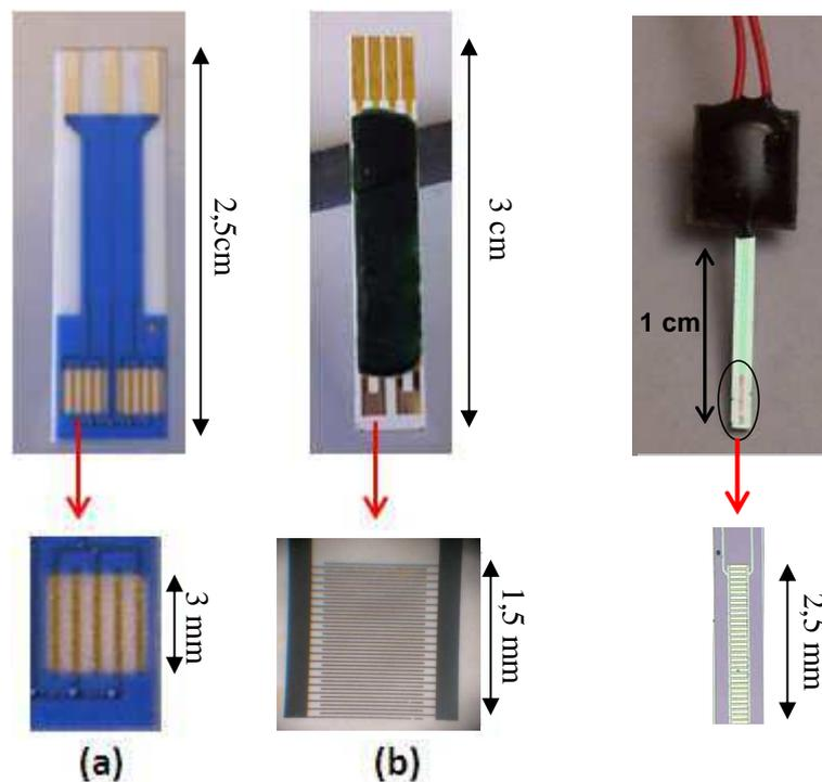
Fig.II.4 : Présentation des trois types de transducteurs interdigitaux utilisés dans ce travail.
