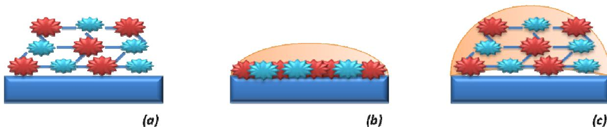
Fig.IV.2 : Représentation schématique des trois modes d'immobilisation sur les surfaces des électrodes
