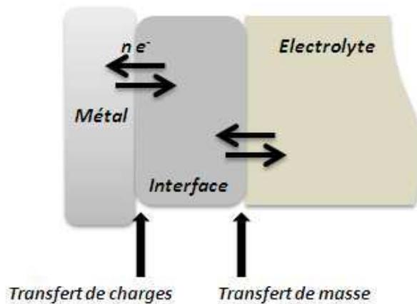
Fig.I.16 : Différents processus électrochimiques à l'interface métal/électrolyte
