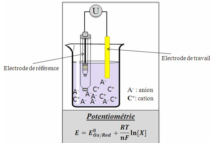
Fig.I.12 : Schéma de principe de la potentiométrie
