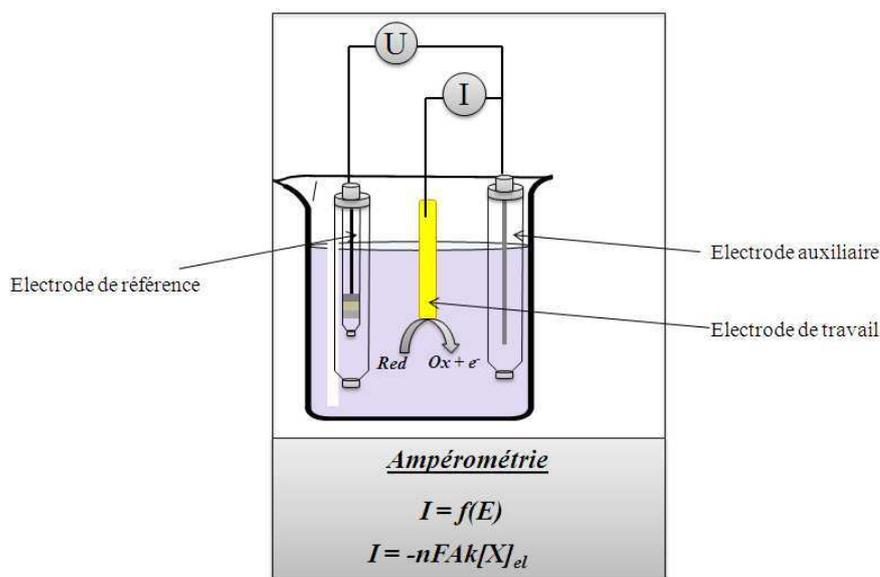
Fig.I.13 : Schéma de principe de la voltammétrie
