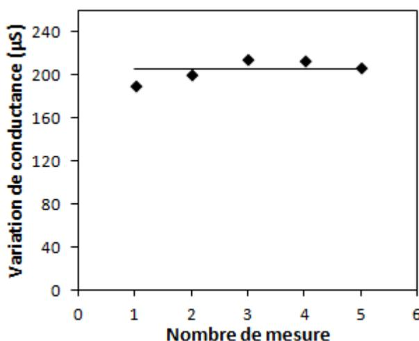
Fig.IV.13 : Reproductibilité à court-terme de la réponse du biocapteur. 0,045 mg de pFDH et 13 µg NAD<sup>+</sup> co-immobilisés dans la biomembrane [HCHO] = 5 mM. 20 µM de NAD<sup>+</sup> ajoutés dans le tampon phosphate 5 mM, pH 7, T = 23±2°C
