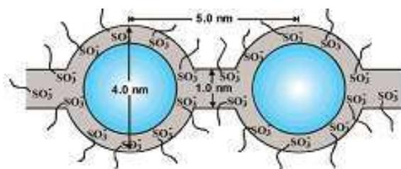
Fig.I.48: Modèle du réseau de « cluster » pour la morphologie du Nafion hydraté<sup>160</sup>
