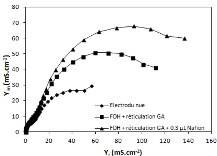
Fig.IV.8 a : Influence des modifications d'électrode sur les diagrammes d'admittance de Nyquist. Potentiel appliqué: 10 mV, gamme de fréquence balayée: 100 MHz - 100 kHz. Mesure en tampon phosphate 5 mM, pH 7
