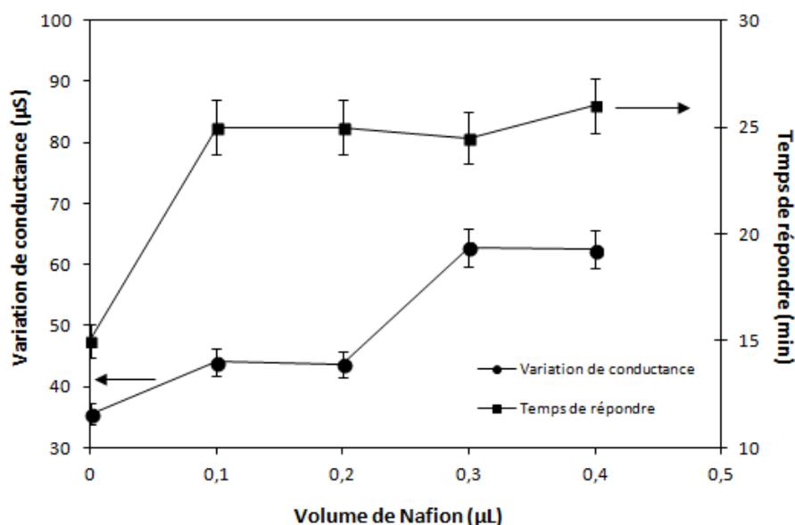
Fig.IV.9 : Effet de l'épaisseur de la membrane Nafion sur le signal du biocapteur (●) et sur le temps de réponse (■).
