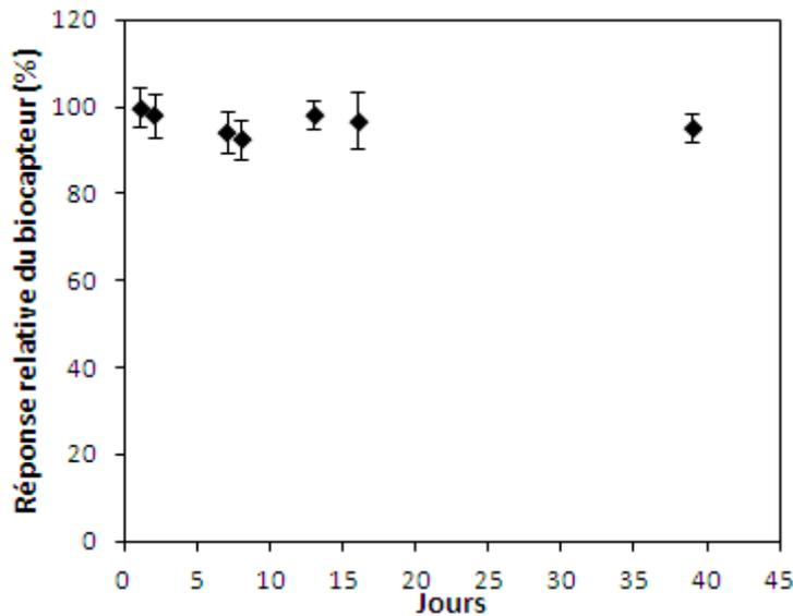
Fig.II.21: Stabilité de stockage du biocapteur bienzymatique AOX/HRP pendant 40 jours.
