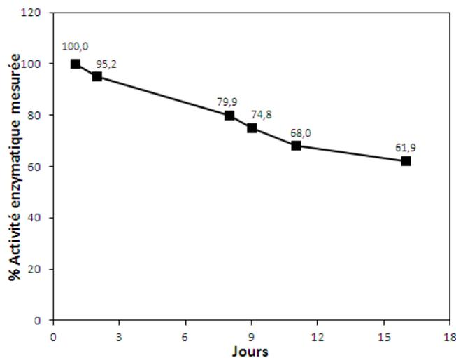
Fig.II.13 : Evolution de l'activité catalytique d'une solution contenant 5% (m/v) d'AOX, 5% (m/v) de BSA et 10% (m/v) de glycérol conservée à  $-20^{\circ}\text{C}$  et subissant des cycles de congélation/décongélation à chaque mesure
