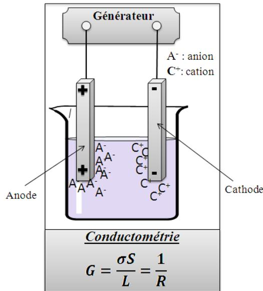
Fig.I.21: Schéma de principe de la conductimétrie
