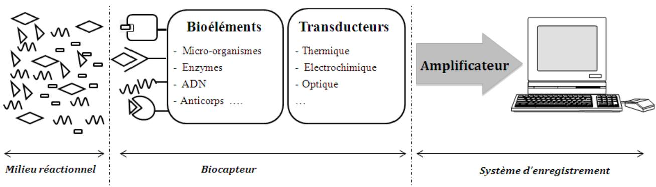
Fig.I.1 : Schéma du principe de fonctionnement d'un biocapteur
