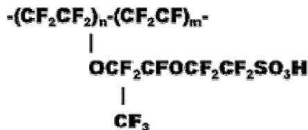
Fig.I.47: Structure chimique du Nafion
