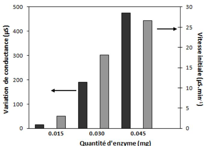
Fig.IV.5 : Influence de la quantité de pFDH sur le signal du biocapteur et sur la pente initiale de la réponse du biocapteur. pFDH et  $\text{NAD}^+$  co-immobilisés dans la biomembrane -  $[\text{HCHO}] = 10 \text{ mM}$  dans du tampon phosphate 5 mM, pH 7, sans ajout supplémentaire de cofacteur en solution,  $T = 23 \pm 2^\circ\text{C}$
