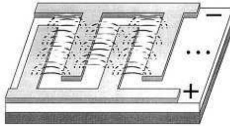
Fig.I.23 : Illustration du procédé de recyclage des espèces redox des électrodes interdigitées<sup>104</sup>
