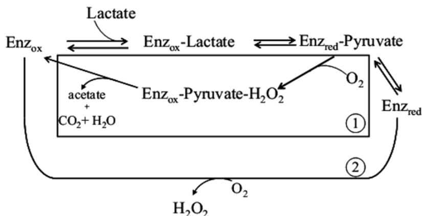
Fig.III.4: Mécanismes d'oxydation enzymatique du L-lactate par la L-lactate oxydase (voie 1) et la L-lactate monooxygénase (voie 2)<sup>29</sup>
