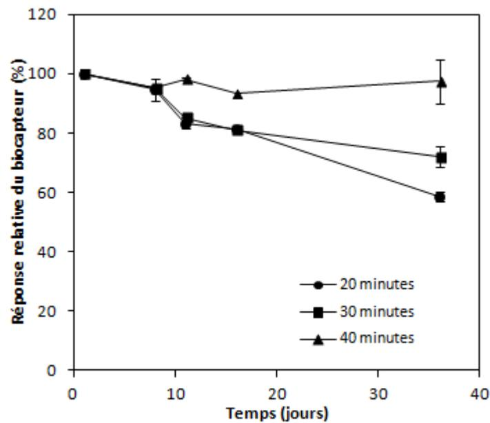
Fig.III.9: Influence du temps de réticulation sur la stabilité au stockage du biocapteur LODP/HRP .
