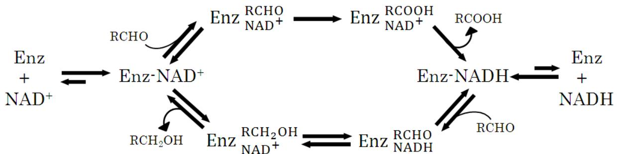
Fig.I.41: Schéma d'un mécanisme possible pour la réaction de dismutation des aldéhydes catalysée par la PFDH<sup>115</sup>
