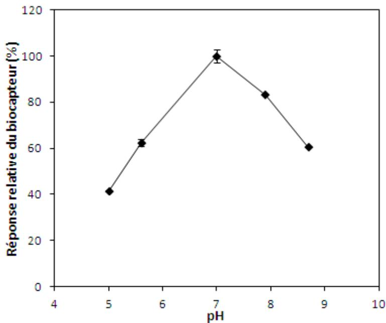
Fig.II.19 : Influence du pH du milieu sur le fonctionnement du biocapteur conductimétrique bienzymatique AOX 5%, HRP 15%. Immobilisation : vapeurs de GA, 30 min. [MeOH] = 2,9 mM. Mesure dans du tampon phosphate 5 mM.
