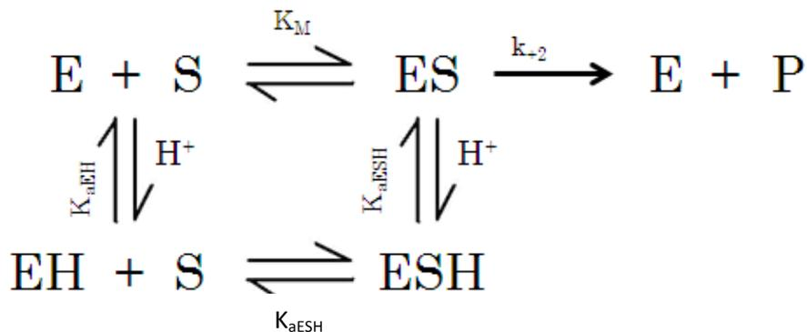
Fig.I.37: Effet du pH sur les équilibres mis en jeu dans la réaction enzymatique<sup>114</sup>
