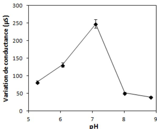
Fig.IV.11 : influence du pH sur le signal du biocapteur conductimétrique
