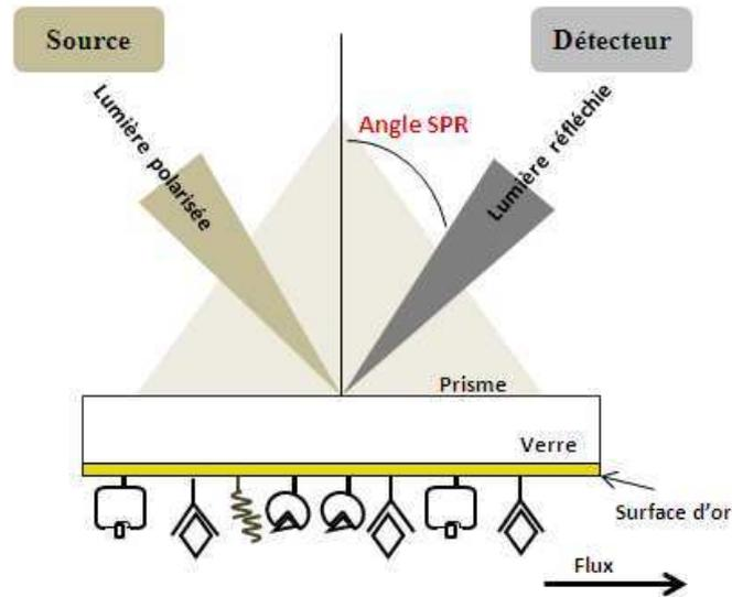
Fig.I.10 : Schémas de principe de la détection SPR
