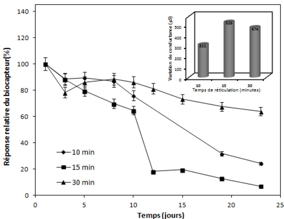
Fig.IV.7: Influence du temps de réticulation sur la stabilité du biocapteur et sur le signal (insert). 0,045 mg de pFDH et 13  $\mu\text{g}$   $\text{NAD}^+$  co-immobilisés dans la biomembrane et la membrane Nafion [HCHO] = 10 mM dans du tampon phosphate 5 mM, pH 7, T = 23 $\pm$ 2°C
