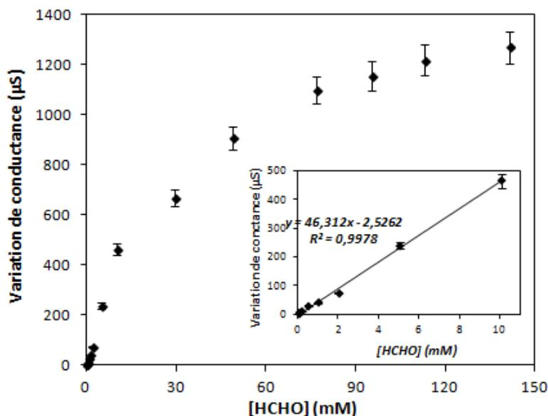
Fig.IV.12: Droite d'étalonnage du biocapteur conductimétrique mesurée dans les conditions optimales. 0,045 mg de pFDH et 13 µg NAD<sup>+</sup> co-immobilisés dans la biomembrane par des vapeurs de GA pendant 30 minutes. Membrane Nafion 20 µM de NAD<sup>+</sup> ajoutés dans le tampon phosphate 5 mM pH 7, T = 23±2°C
