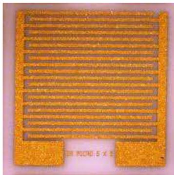
Fig.I.22 : Structure en bandes parallèles des électrodes interdigitées
