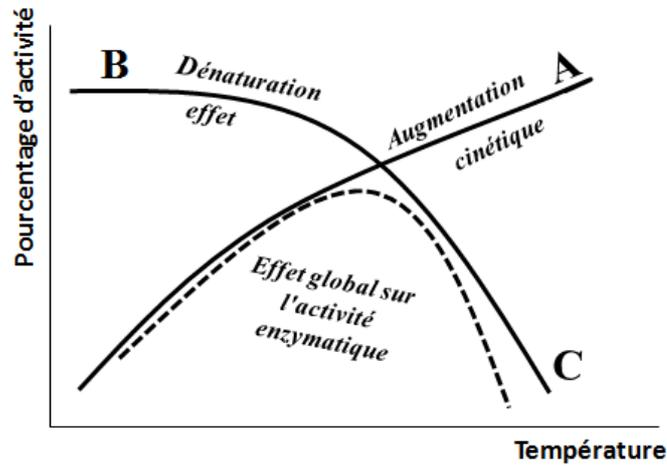
Fig.I.36: Effet de la température sur la vitesse d'une réaction chimique (A), sur la dénaturation d'une enzyme (B) et sur l'activité globale d'une enzyme<sup>114</sup>
