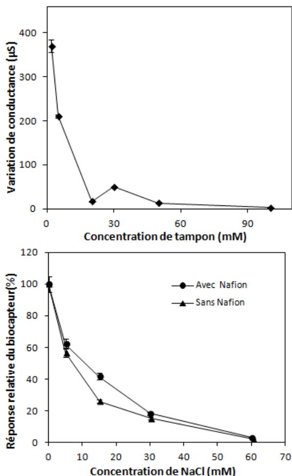
Fig. IV.10 b: Influence sur la réponse du biocapteur de la concentration en tampon (a) ou de NaCl (b) en présence (●) et en absence (▲) de membrane Nafion. 0,045 mg de pFDH et 13 µg  $NAD^+$  co-immobilisés dans la biomembrane par GA vapeur pendant 30 minutes  $[HCHO] = 2 \text{ mM} - 20 \text{ µM } NAD^+$  ajoutés dans le tampon phosphate 5 mM, pH 7,  $T = 23 \pm 2^\circ C$
