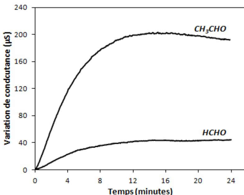
Fig.IV.16: Réponses du biocapteur à pFDH sans membrane Nafion vis-à-vis du formaldéhyde et de l'acétaldéhyde. [Aldéhyde] = 4 mM dans tampon phosphate 5 mM pH 7
