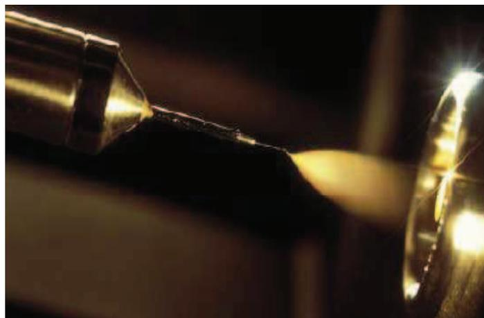
Figure 2.2 : Schéma de principe du fonctionnement d'une source électrospray
