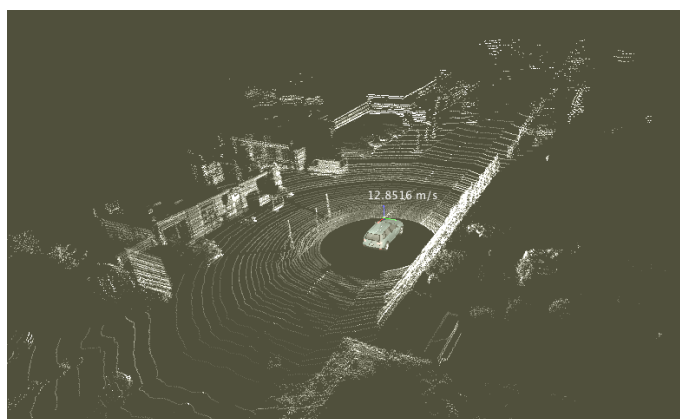
(b) Illustration d'un scan fourni par le lidar Velodyne de l'université de Munich
