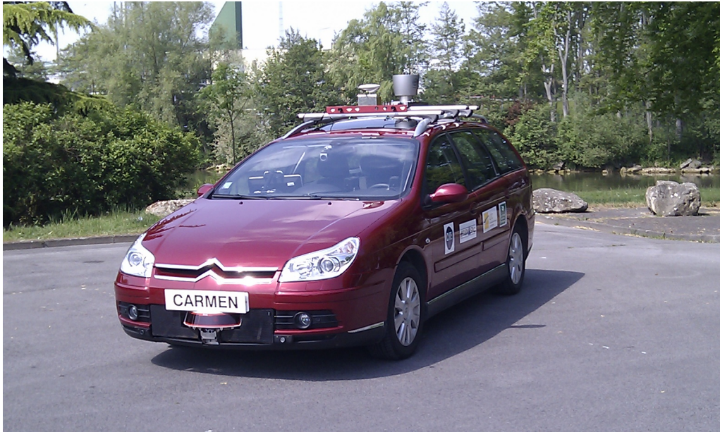
Figure 5.22.: Le véhicule expérimental Carmen : le lidar est intégré dans la calandre du véhicule
