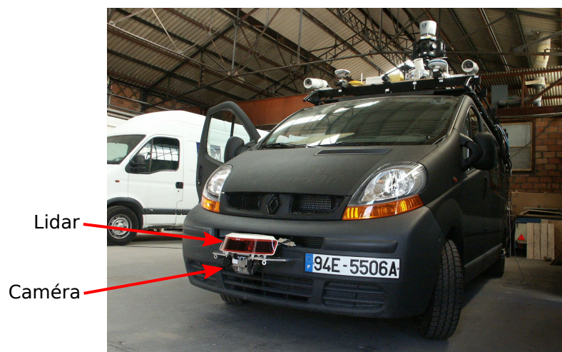
Figure 5.2.: Véhicule utilisé pour l'enregistrement du jeu de données. Le capteur Alasca est installé sur le pare-choc avant et la caméra montée en dessous est protégée par un cache.
