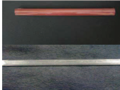
Figure III.13. Image d'un tube de pyrex enduit de pyrène (en bas) et de l'oxyde de fer (en haut).
