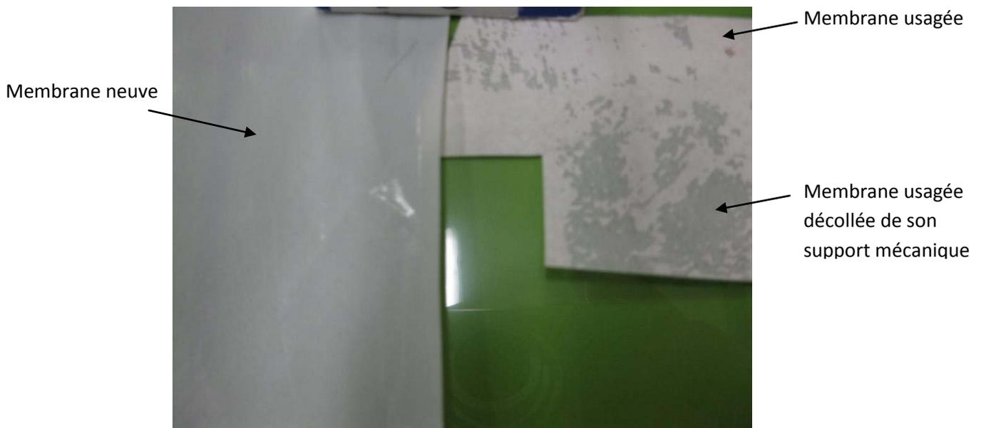
**Image V-1 : Photo comparative d'une membrane neuve et d'une membrane usagée**
