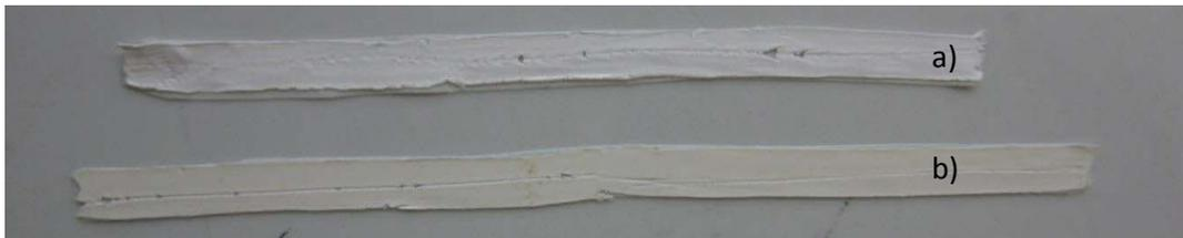
**Image V-4 : Photo comparative d'une fibre creuse neuve (a) et usagée (b)**
