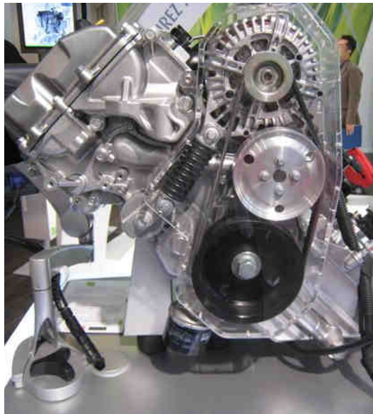
FIGURE C.1 – Exemple de SSG pour mild hybrid (système stars-x Valeo sur un moteur smart)
