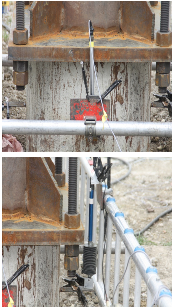
Figure II-21 : Capteurs LVDT : a) de 50 mm de course b) de 125 mm de course
