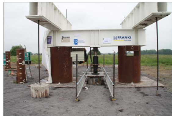
Figure 4 : Dispositif de chargement des pieux en compression.
