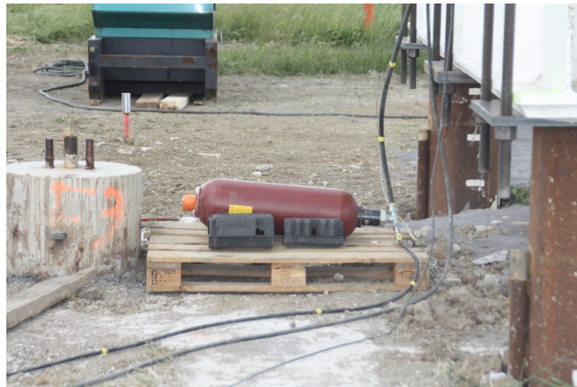
Figure II-29 : Photo de l'accumulateur
