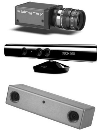
Figure 28 : Différents types de caméras vidéo. Dans l'ordre : infrarouge, de profondeur, stéréoscopique.
