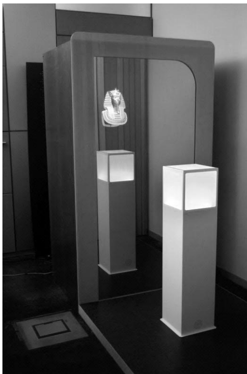
Figure 23 : L'HoloCubtile. L'utilisateur peut déplacer et orienter l'objet en 3 dimensions affiché sur le miroir en manipulant les surfaces du cube.
