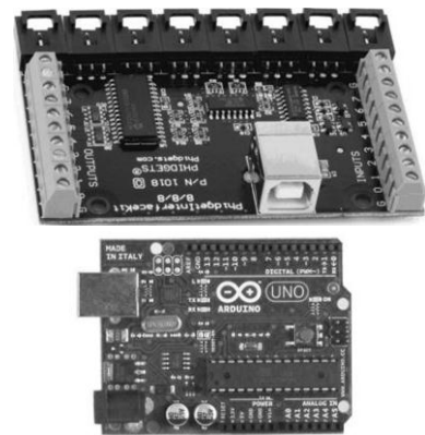
Figure 29 : Microcontrôleurs Phidgets et Arduino
