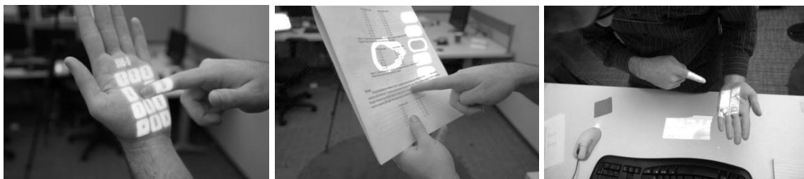
Figure 17 : Plusieurs illustrations du système Omnitouch : le doigt comme pointeur, une feuille comme surface d'interaction, la main comme surface d'interaction
