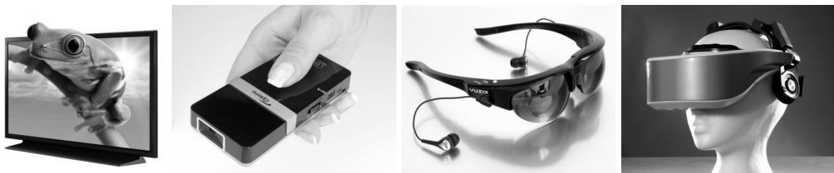
Figure 30 : Différents dispositifs de visualisation. Dans l'ordre : écran auto-stéréoscopique, pico-projecteur, lunettes semi-transparentes, casque de réalité virtuelle.
