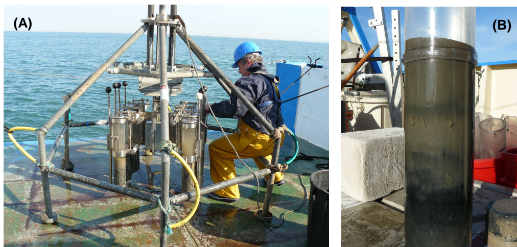
Figure 3.3 Vue du carottier multitube MUC 8/100 (A) et d'une carotte de sédiment (B).
