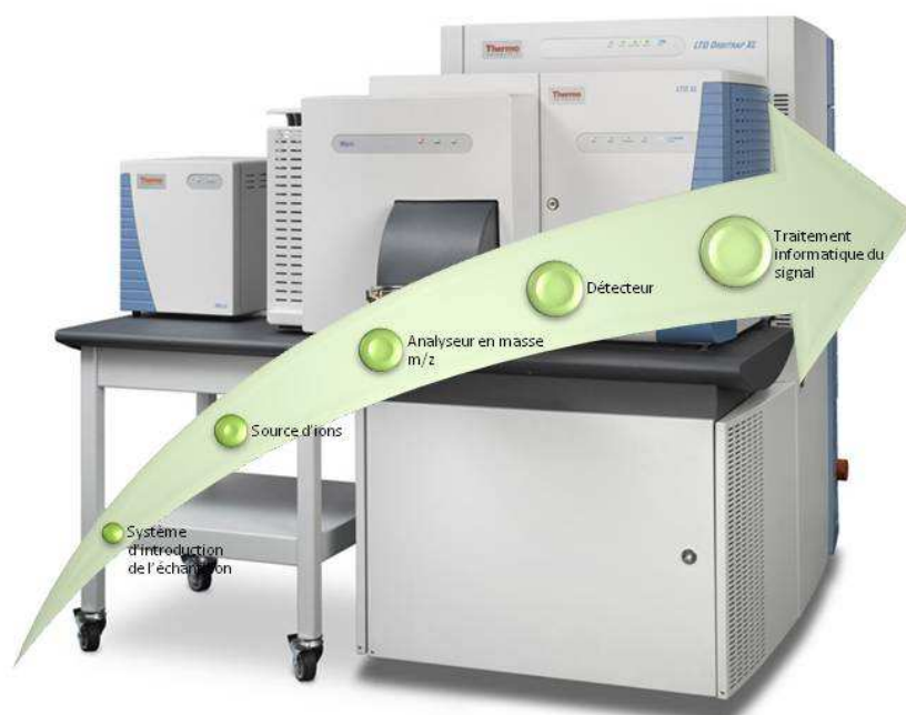
Figure 6 : Schéma général des étapes de fonctionnement d'un spectromètre de masse
