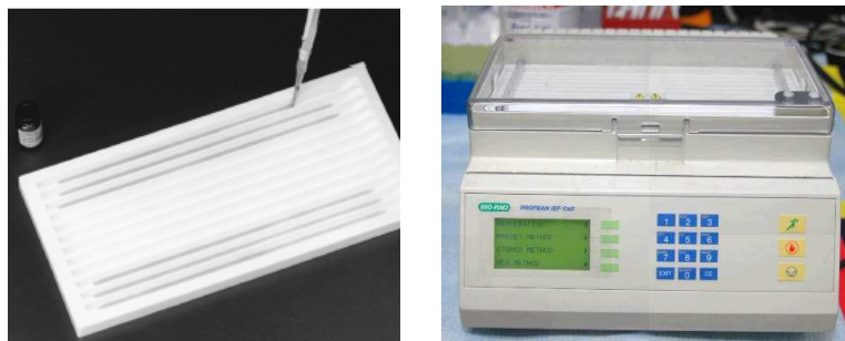
Figure 127 : image du portoir pour l'hydratation passive des échantillons et de l'appareil IEF Cell (Biorad)
