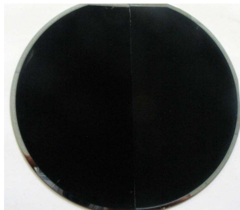
Figure II-1. Image d'un wafer entier de Black Silicon obtenu par DRIE cryogénique.
