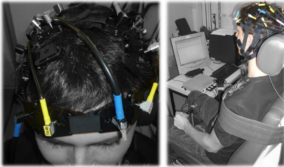
Figure 32 – Détail sur la localisation des optodes NIRS sur le CPF. Un émetteur et un récepteur étaient espacés de 35 mm et positionnés symétriquement sur la partie dorsolatérale du CPF droit et gauche. La couleur bleue représente les fibres optiques des récepteurs et les jaunes celles des émetteurs. Pour améliorer la stabilité des optodes sur le front, un adhésif double-face transparent était disposé sous les optodes.
