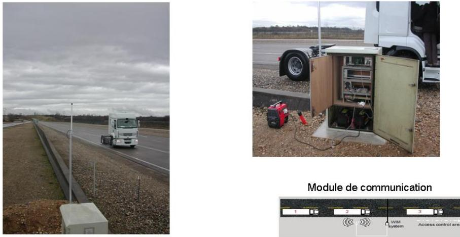
Figure 7.11: Communication Véhicule et système WIM : (1) Identification du véhicule, (2) Dialogue Véhicule et le système WIM, (3) Fin de communication
