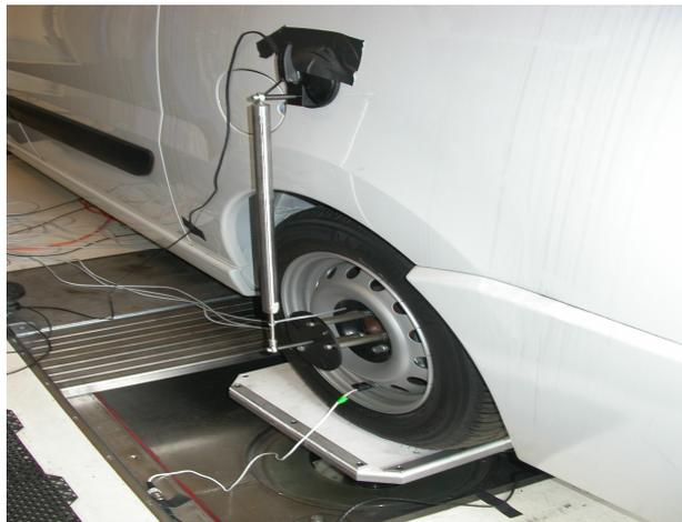
Figure 8.35: Vérin hydraulique excitant le véhicule
