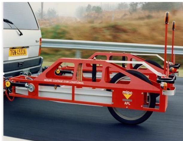
Figure 7.33: APL: Analyseur de Profil en Long
