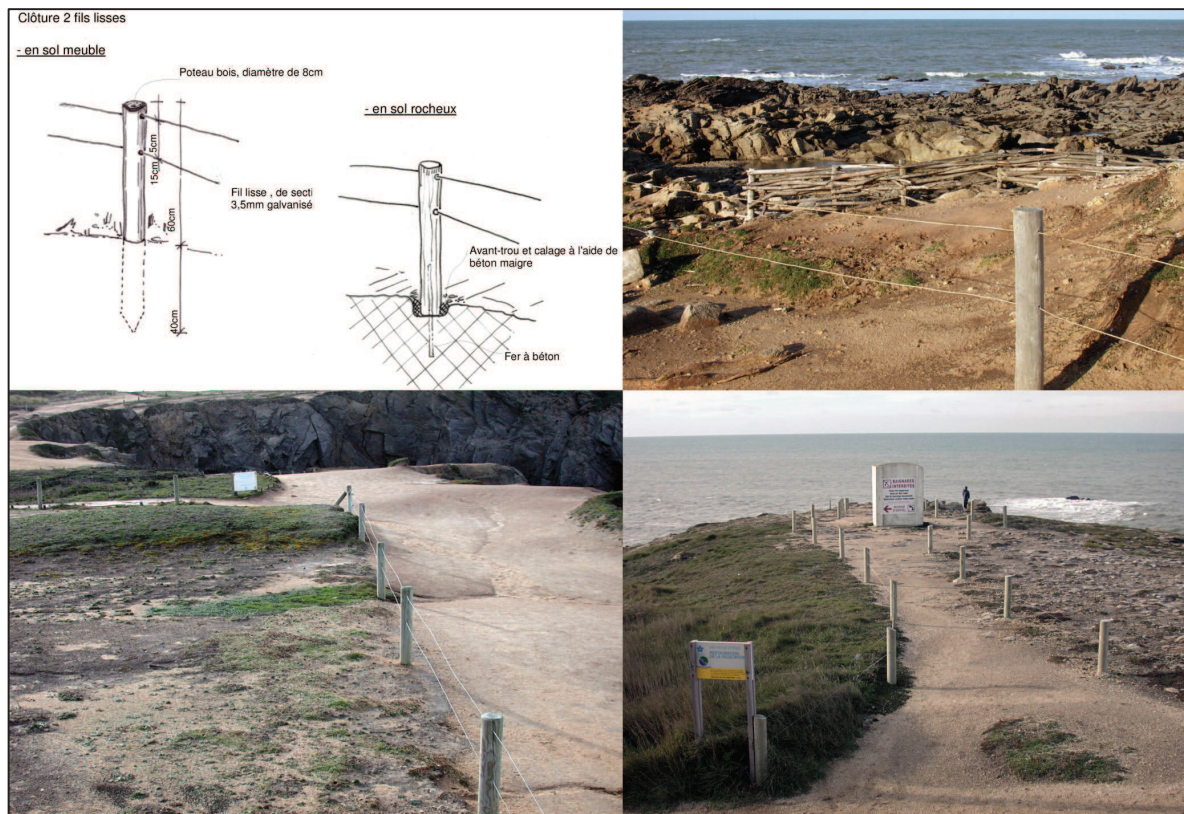
Figure 81 : Schéma et photos de la technique du bifil mis en place à la côte sauvage de Quiberon
