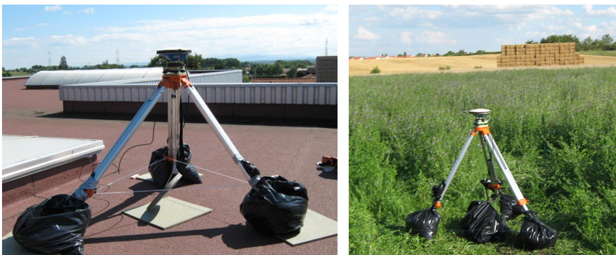
Figure B.2. Les deux principaux types d'installation de stations GPS pendant la campagne : sur un toit (station B4MA, à gauche, cf. Figure B.1 pour la localisation des stations) et au sol (D3LU, à droite). Les sacs en plastiques noirs contiennent du lest (terre et/ou gravier). Un lest central est aussi ajouté. Pour B4MA le récepteur et la batterie de sécurité étaient posés au sol, emballés dans un sac plastique pour les protéger de la pluie.
