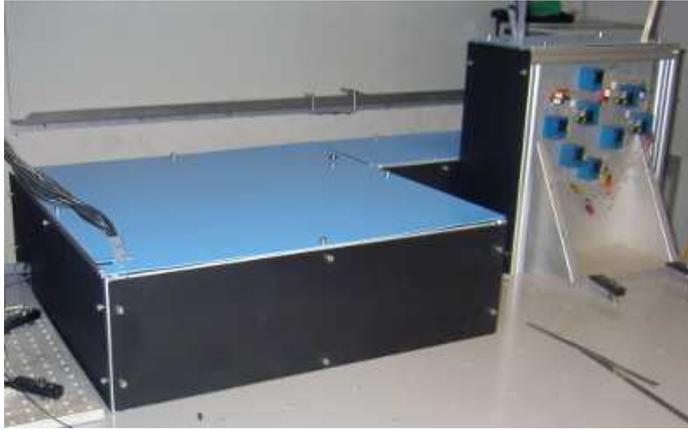
FIGURE 3.7 – Enceinte d’isolation acoustique et thermique de l’interféromètre
