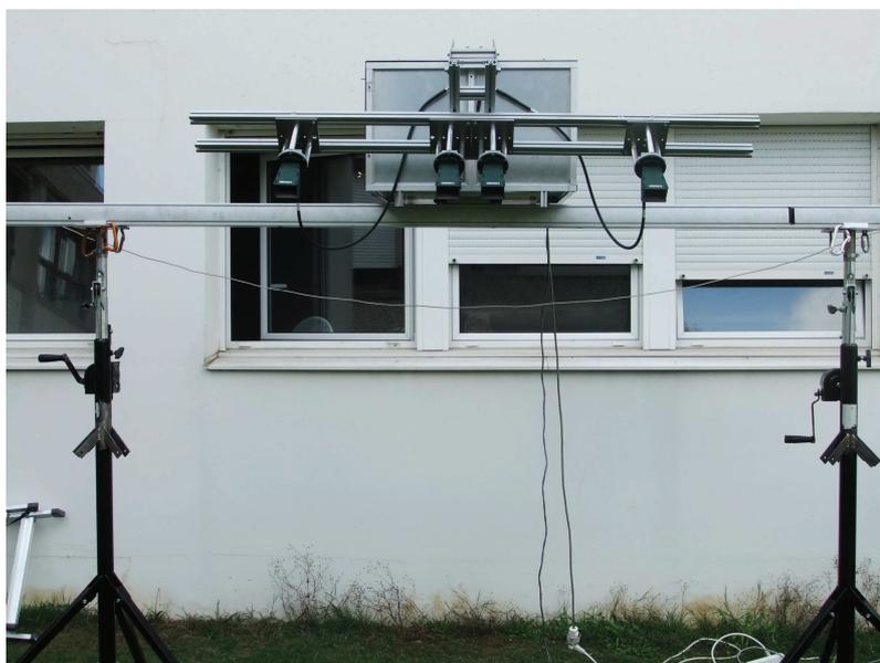
FIGURE 4.16 – Aperçu du système d'imagerie MIMO SAR
