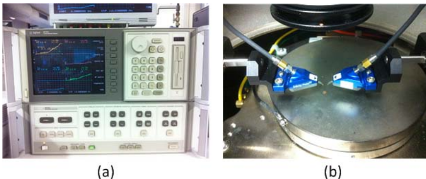
FIGURE 3.21 – Photographie du banc de mesures : (a) Analyseur de réseaux vectoriel. (b) Station sous pointes
