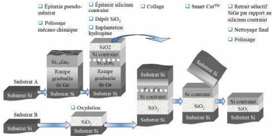
Figure IV.15 Procédé de fabrication d'une plaque sSOI
