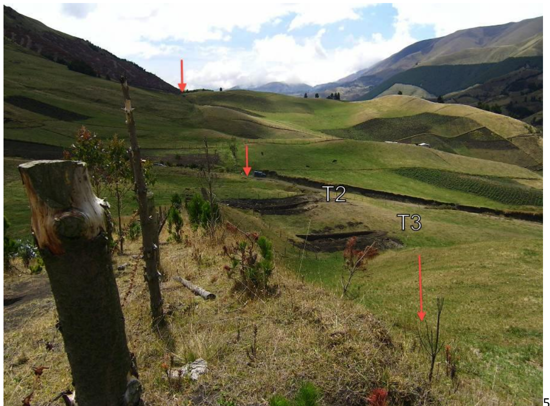
Figure 2.8 : Segment Rumipamba (système de faille Pallatanga). Les flèches rouges montrent la trace de la faille et indiquent la localisation de deux des trois tranchées réalisées sur la faille.
