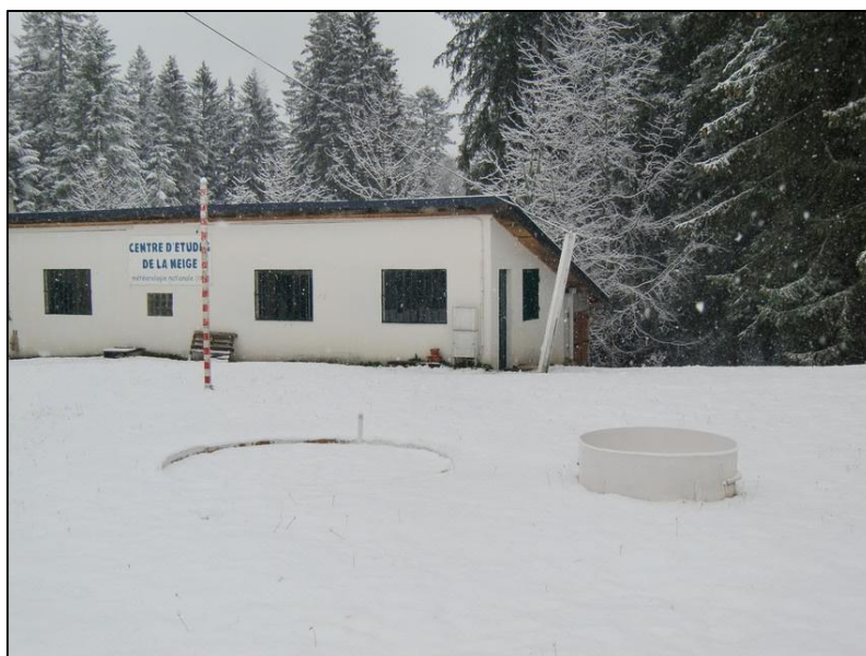
Figure 11- Lysimètre 5 m 2 (à gauche) et 1m 2 (à droite, avec jupe) sur le site d'études du CEN au col de Porte (photo prise le 6 décembre 2011).
