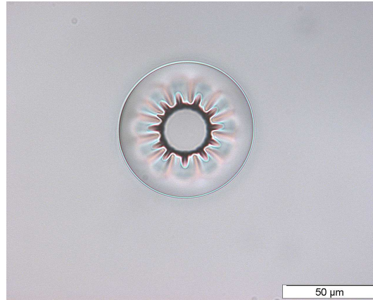
FIGURE 5.14 – Image de microscopie optique d'une déformation caractéristique du gel, observée dans un gel contenant des capsules de 10 bicouches.
