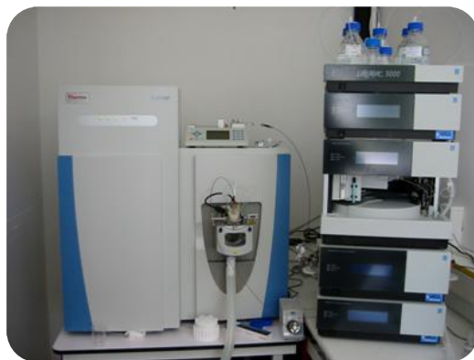
Figure 32: Chaîne de chromatographie liquide UHPLC Dionex Ultimate 3000 (à droite sur la photo) couplée au spectromètre de masse Thermo Exactive (à gauche sur la photo).
